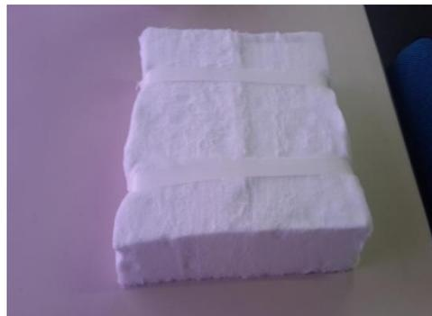
O Módulo REFIPAR é um bloco constituído de tiras de fibra cerâmica multi-agulhada, utilizada para a linha de fornos industriais. Os módulos são fabricados a partir de misturas de materiais sintéticos de alta pureza, os quais são utilizados tanto para produzir as fibras cerâmicas Grau R (alumina-sílica) ou Grau H (alumina-zircônia-sílica).
